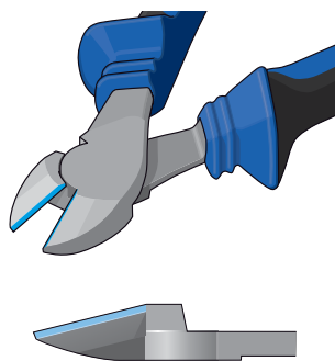
Corte diagonal Para corte com menor esforço, por maior número de vezes; corte preciso
